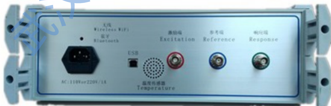
变压器绕组变形后面板
