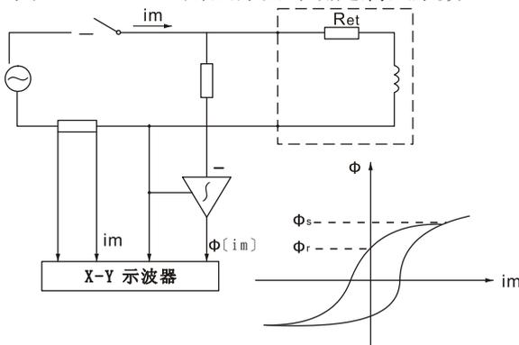
TPS 和 TPX 级电流互感器的铁芯必须先退磁, 退磁的 TPY 级电流互感器的剩磁系数 ( $K_r$ ) 用比  $\Phi_r/\Phi_s$  确定。
