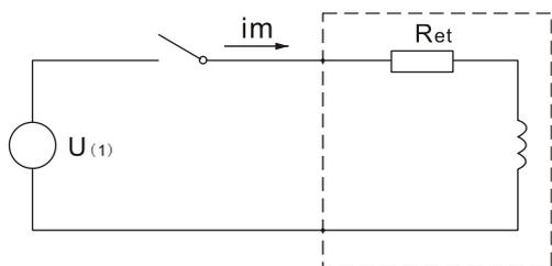
图 E. 0. 2-2 用磁滞回环确定剩磁系数  $K_r$ 。
